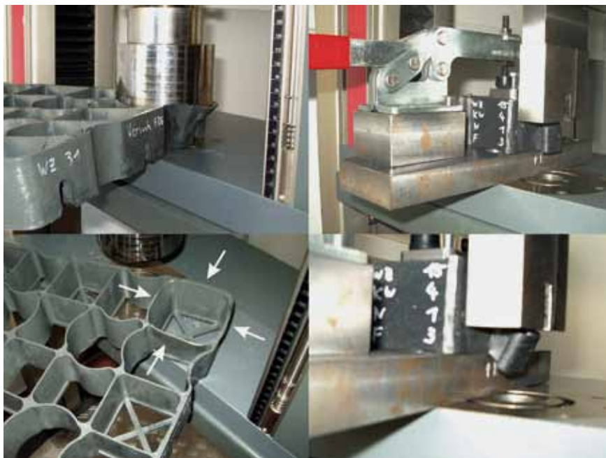
Bild 3: Laborprüfungen: Druckversuch in Gitterwabe (linke Bilder), Abscherprüfung an Rastnase (rechte Bilder)
