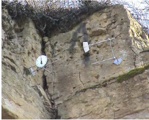
Abb. 9: Mechanisch arbeitende Messuhr mit einer Ablesegenauigkeit von 2 mm Fig. 9: Mechanical measuring instrument with an accuracy of reading of 2 mm
